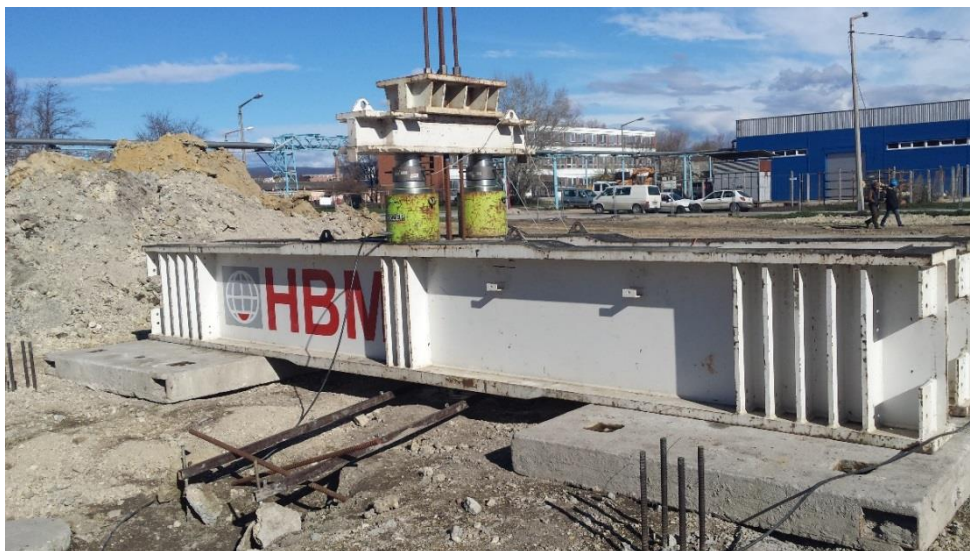
8.2. kép: húzóterheléses statikus próbaterhelés betonlapokkal alátámasztott híddal
