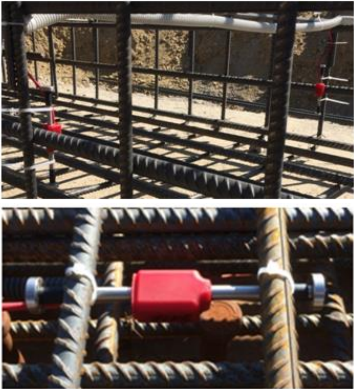
20. ábra. Alkalmazási példa - alaptest függőleges alakváltozás mérése (forrás: A-Híd Zrt.)
