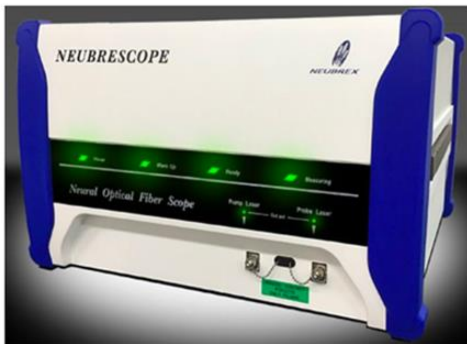
33. ábra. optikai szálak mérések - kiolvasó egység (forrás: ???)
