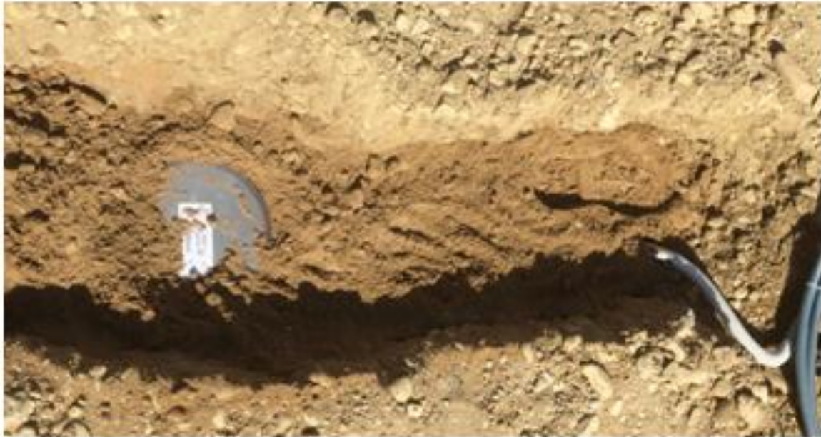
23. ábra. Alkalmazási példa - alaptest alatti függőleges feszültségek mérése (forrás: A-Híd Zrt.)
