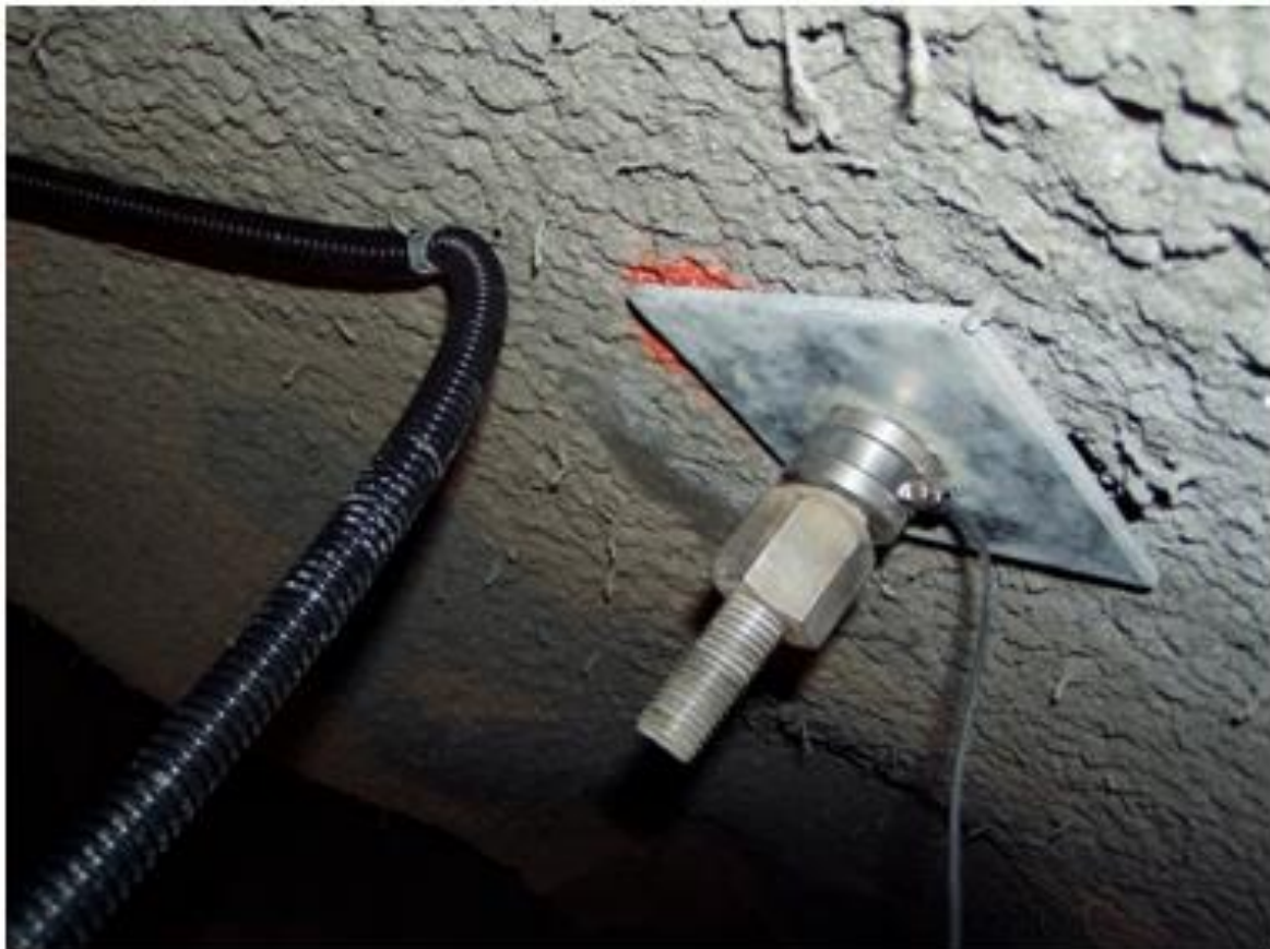
25. ábra. Egy horgonyfejre telepített elektronikus terhelésmérő cella (Load Cell) (forrás: Kőmérő Kft.)
