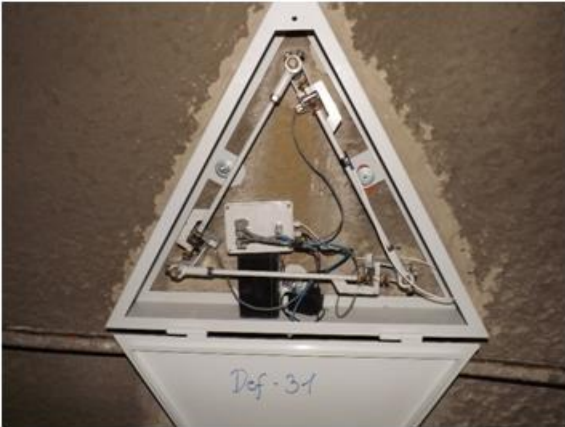
17. ábra. Egy háromszöges elrendezésben telepített mérőbéllyeges-mérőnyelves deformációmérő állomás (forrás: Kómérő Kft.)
