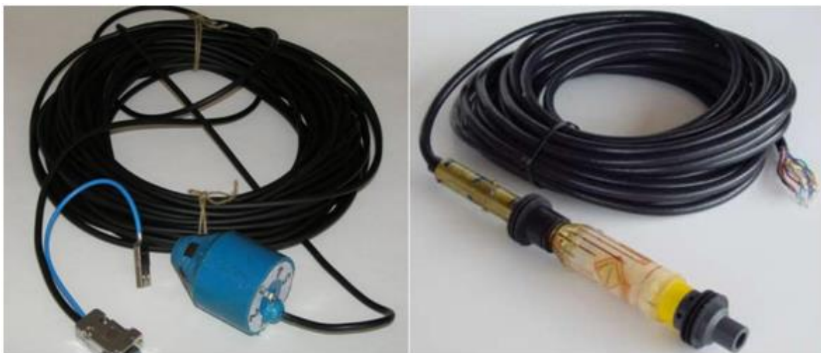
26. ábra. 3D feszültségváltozás-mérésre is használható mérőcellák. Bal oldali kép: egy CCBO típusú szonda (forrás: Institute of GEONICS, Csehország); Jobb oldali kép: egy CSIRO HI típusú mérőcella (forrás: ESS Earth Sciences, Ausztrália)
