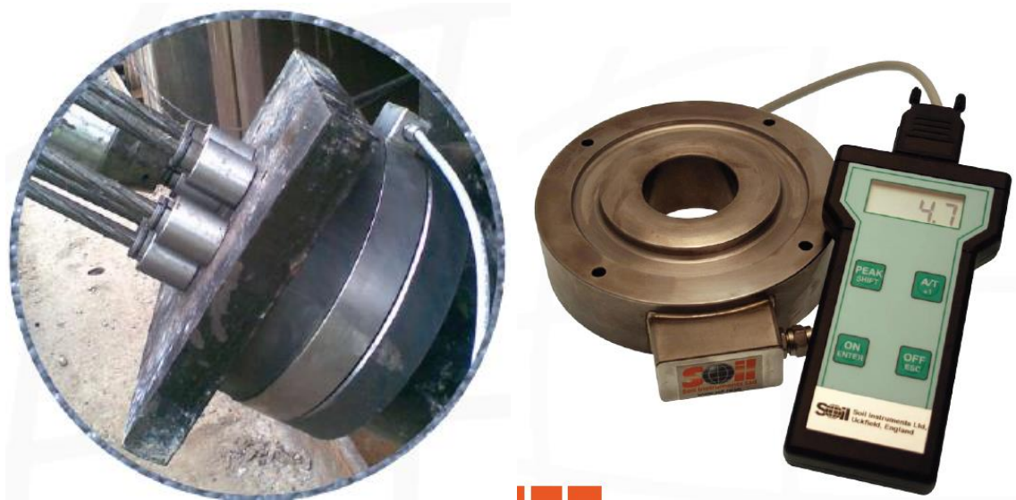
40. ábra. Belvárosi beépítés - erőmérő cella (dúcerő, horgonyerő mérésére)
