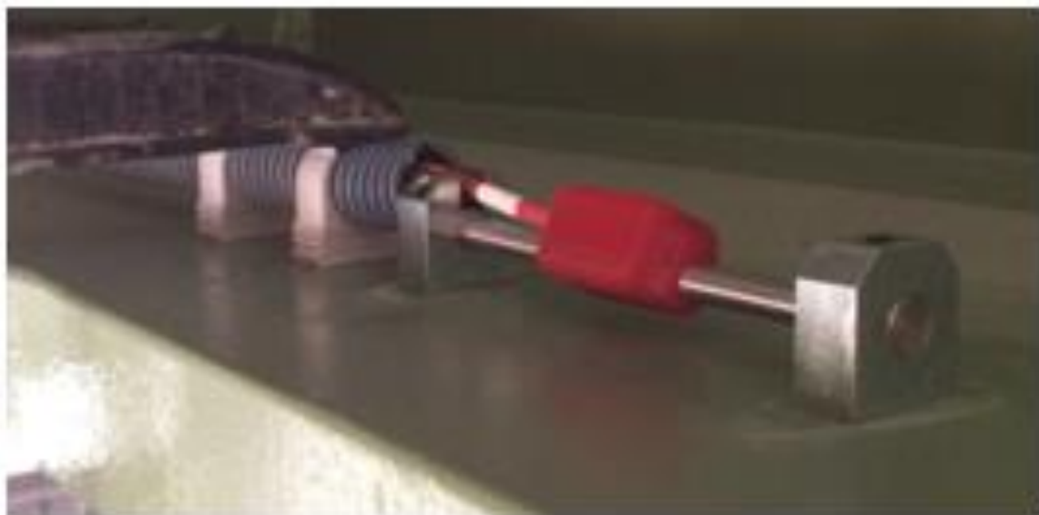
19. ábra. alkalmazási példa - hídgerenda alakváltozásának mérése hegesztett kivitelű rezgőhúros műszerrel (forrás: A-Híd Zrt.)
