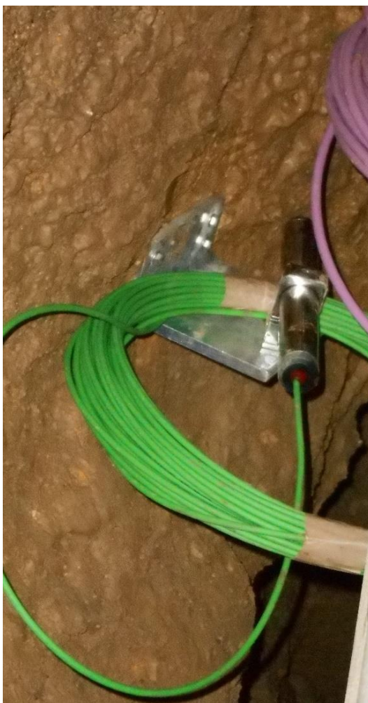
58. ábra. Barlangi mérések - kőzettömb mozgásmérése dőlésmérővel (KBFI Alfa Kft. felvétele)
