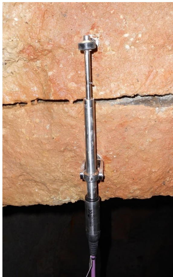
56. ábra. Barlangi mérések - repedéstágasság mérések a kőzetfedőben (KBFI Alfa Kft. felvétele)
