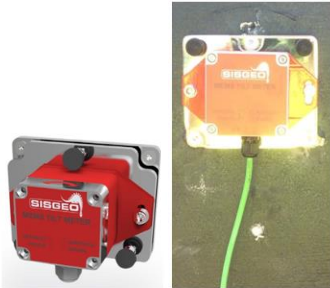
15. ábra. Egy példa dőlésmérő műszerre (bal oldali kép – forrás: www.sisgeo.com ) és egy alkalmazási példa szerkezeti fal dőlésmérésére (jobb oldali kép – forrás: A-Híd Zrt.)
