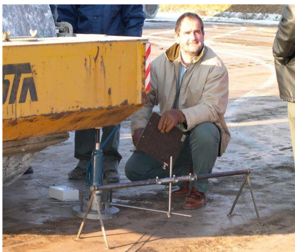
17. fénykép: Statikus tárcsás és könnyű ejtősúlyos teherbírás mérés (forrás: EFERTE)
