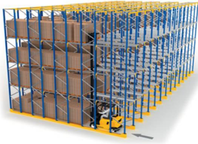
9. ábra: Bejárható állványrendszer
