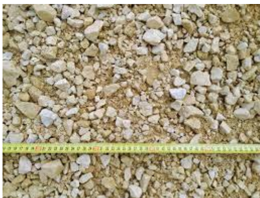
11. fénykép: Folytonos szemeloszlású zúzottkő (forrás: www.dolomit-gant.hu )
