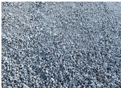
12. fénykép: Minőségi törtbeton (forrás: www.bekaslogistic.hu )
