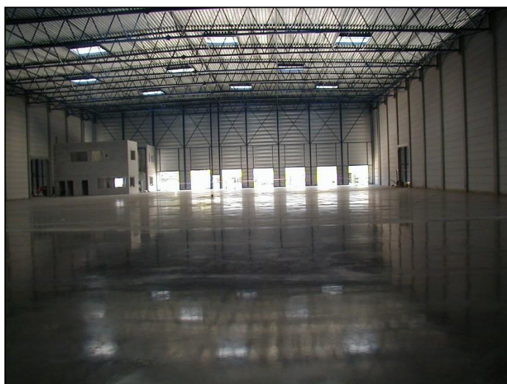
2. fénykép: Vágottfuga-mentes (jointless), ipari padló - Raktár csarnok, Gyál (forrás: Betonmix)
