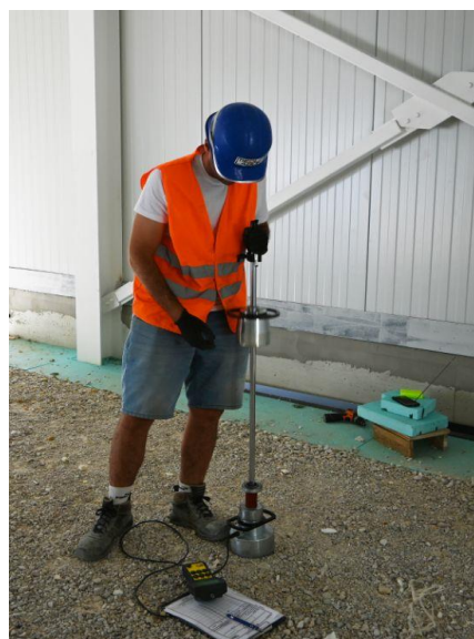
17. fénykép: Statikus tárcsás és könnyű ejtősúlyos teherbírás mérés (forrás: EFERTE)
